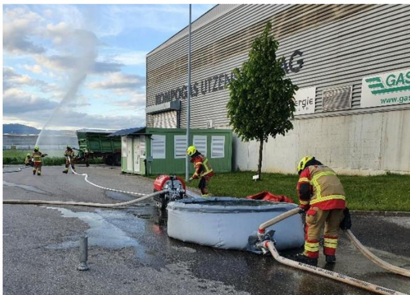
**Ausgleichsbecken mit zwei Zubringerleitungen. Ein «verkehrt» eingebautes Teilstück dient als Sammelstück und zum Regulieren der Wassermenge.**
