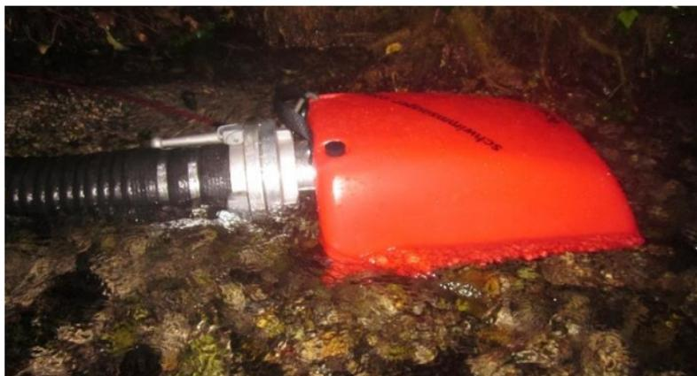
**Schwimmseiler, minimale Wasserhöhe.**
