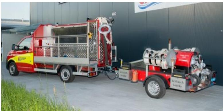
Schlauchverlegefahrzeug mit Motorspritzenanhänger.
